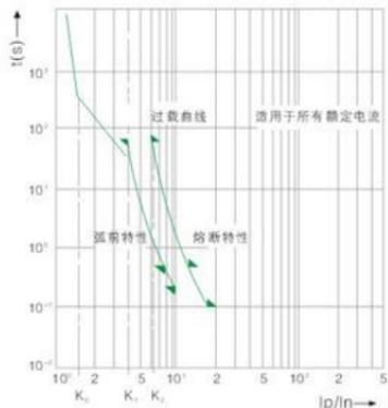
'(aM)' 熔断体的时间——电流带
